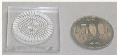
図2 波面センサ用マイクロレンズアレー
