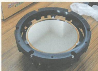
図4 製作した特注の可変形鏡（直径130 mm）
